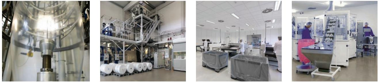
Alle Prozesse finden in gekapselten und überwachten Reinräumen statt: Schlauchfolienextrusion, Beutelkonfektion, manuelle Konfektionsprozesse und Verpackung. Ein integriertes Monitoring - System sichert die Reinraumprozessqualität.
