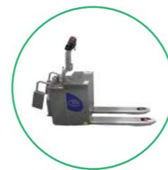
Dotato di pedana operatore ribaltabile e bracci laterali di protezione in AISI 304, adatto per operazioni di movimentazione intensiva. Raggiunge una velocità di trazione di 9 km/h, garantendo spostamenti rapidi su lunghe percorrenze.
