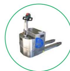
Ideale per essere utilizzato per operazioni di movimentazione fino a 2,0 tons. Gli affidabili impianti elettronici garantiscono elevate prestazioni durante le attività produttive. Applicazione su turni diversi grazie alla facile estrazione laterale della batteria.
