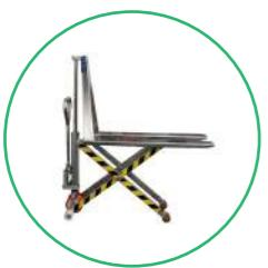
100% AISI304, alzata fino a 800 mm, progettato per mantenere la merce all'altezza adeguata per raccogliere/ depositare i carichi riducendo lo sforzo dell'operatore. I rulli stabilizzatori laterali garantiscono stabilità e sicurezza per l'operatore.
