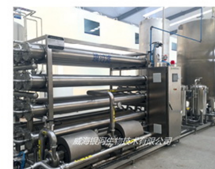
超滤系统 Filtration system
